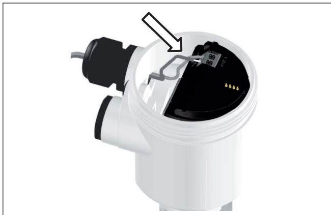
Рис. 17: Шаги подключения 5 и 6 - однокамерный корпус
